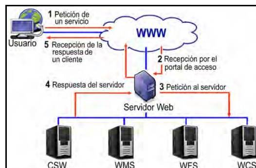
Figura 3. Funcionamiento de un servidor Web.
