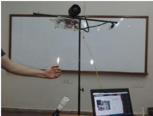
Figura 9. Prueba de detección de intensidad de llamas para establecer rango de lectura de sensor de detección de llamas.
