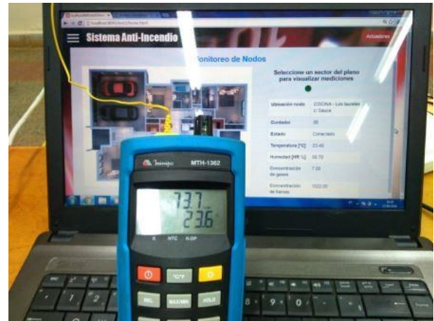
Figura 11. Comprobación de precisión del sensor de temperatura en comparación al termohigrómetro.
