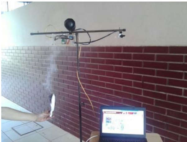
Figura 10. Prueba de detección de humo para establecer rango de lectura de sensor de detección de llamas.
